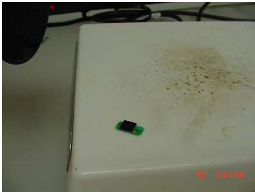
图 8 在偏离中心部位对模块进行预热
